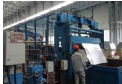
Inspeção da qualidade da superfície de bobinas laminadas a quente
