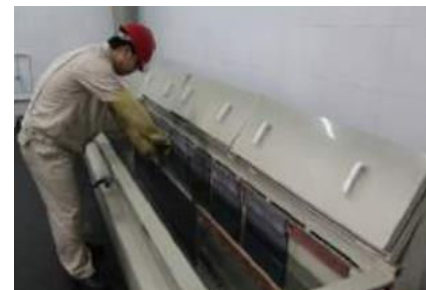
Inspeção da superfície anodizada de chapas laminadas a quente
