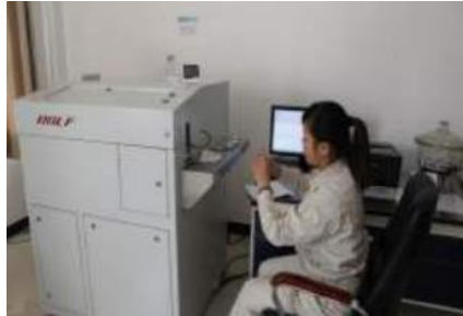
Espectrômetro alemão OBLF-QSN 750-2
