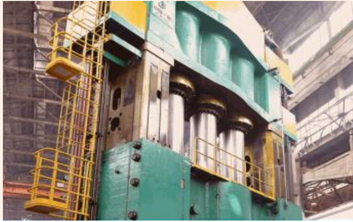
Prensa de forja manual a óleo de 100MN
