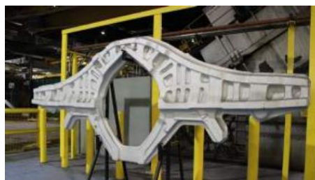
Viga de asa forjada em alumínio
