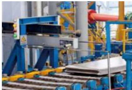
Teste de coroa IMS de saída de laminação bruta
