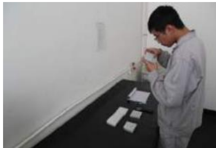
Inspeção de baixo poder do lingote
