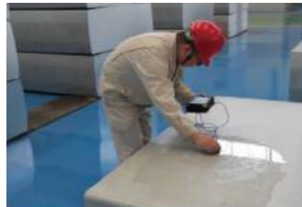
Inspeção de defeitos no lingote
