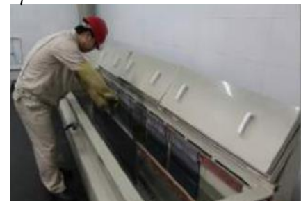
Sıcak haddelenmiş levhaların anodize yüzey muayenesi
