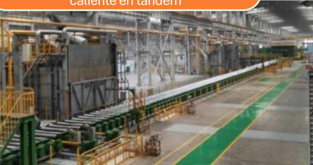
La empresa ha construido un horno de calentamiento por gas inclinable hidráulico que fue diseñado por Otto Junker y fabricado por Suzhou Xinchangguang. Este horno está equipado con un sistema de agitación electromagnética ABB, así como sistemas de medición de hidrógeno y escoria en línea.
