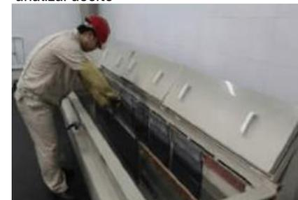
Inspección de superficie anodizada de placas laminadas en caliente
