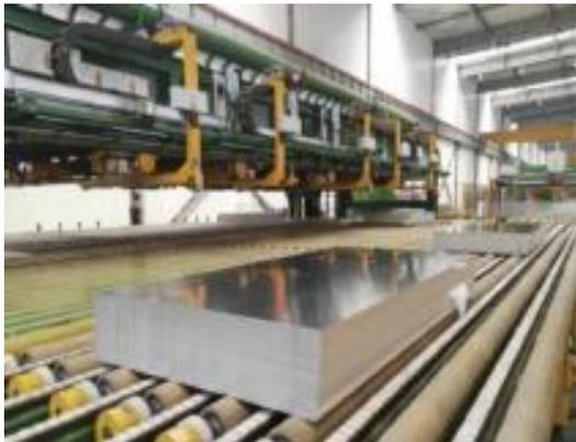
2 líneas de producción de máquinas de corte transversal de placas delgadas
