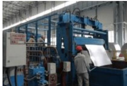
Inspección de calidad de superficie de bobinas laminadas en caliente
