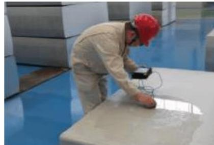
Inspección de fallas on ingot
