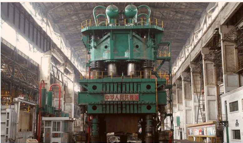
300MN vertical hydraulic die forging press
